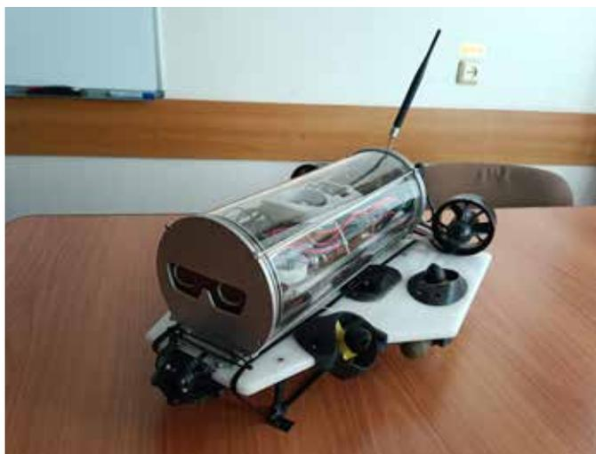
Рис. 1. Внешний вид необитаемого подводного аппарата *Geek*
