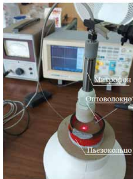
Рис. 1. Схема рабочей камеры малых волновых размеров с «жесткой» стенкой и «мягкими» торцевыми границами, распределение звукового давления в объеме (слева). Вид экспериментальной установки (справа)
