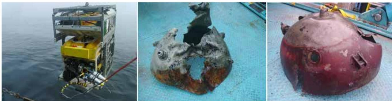
Рис. 10. Система обезвреживания мин гарпунного типа на ТНПА «Panther Plus», обезвреженные мины с участка «Северного потока»
