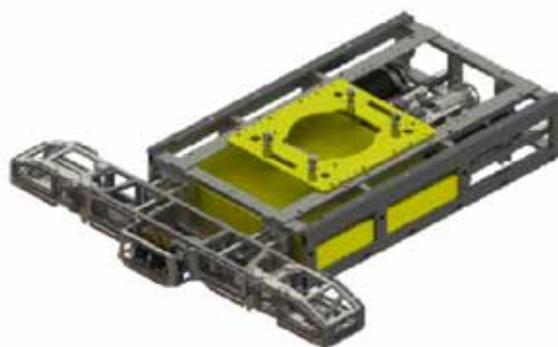
Рис. 15. Устройство формирования изображения под дном
