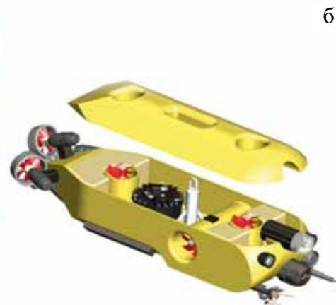
Рис. 7. Состав КПК (а); вариант ТНПА с системой установки заряда (б)
