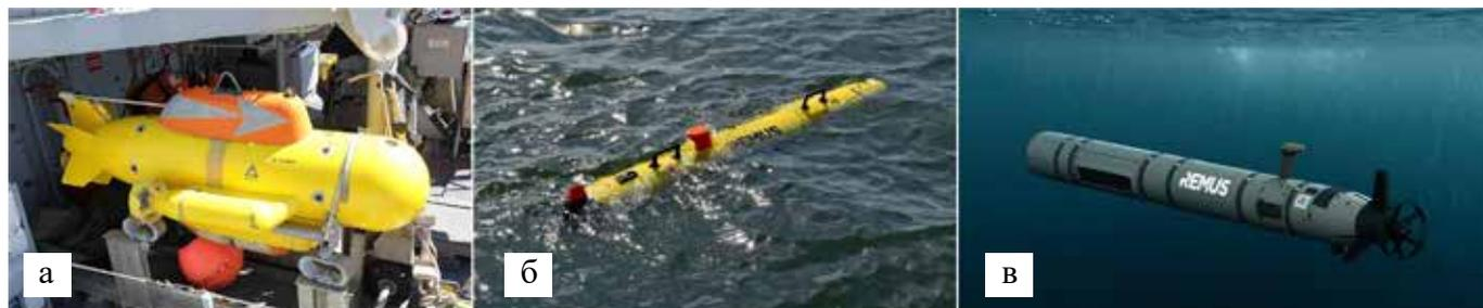
Рис. 2. Противоминный СТПА PAP-104 (а); АНПА REMUS 100 (вес – 49 кг, скорость до 5 узлов, время работы до 8 часов при 5 узлах) (б); АНПА REMUS 600 (вес – 240 кг, скорость до 4 узлов, время работы до 24 часов) (в)
