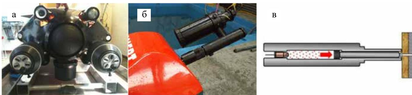
Рис. 11. Магнитный захват (а); BALLISTA 400, прикрепленная к носовой части инертной мины (б); схема работы гвоздомета (в)
